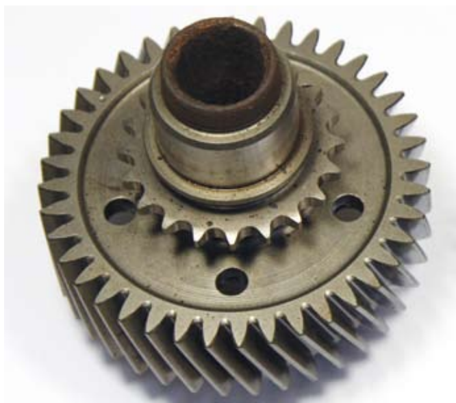
Шлицевое соединение торсионного валаразрушено коррозией из-за отсутствия сезонного ТО в течение нескольких лет. Сопряженные де тали подлежат замене. Мотор — Suzuki DF250.
