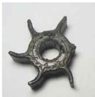
Не заменив своевременно крыльчатку помпы водяного охлаждения, клиент остался один на один с неисправным двигателем (за 160 км от места базирования).
