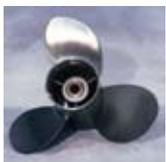
и внешней кромках лопасти увеличивает шаг. Применение стандартного интерцептора обычно выражается в снижении оборотов на 200–400 об./мин. Это означает, что в случае замены обычного винта на винт с интерцептором потребуются снижение шага на 1–2 дюйма.
